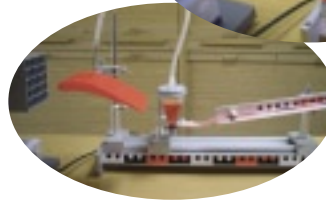
Versuchsaufbau zum Messen der Druckverhältnisse am Tragflächenmodell im Luftstrom
